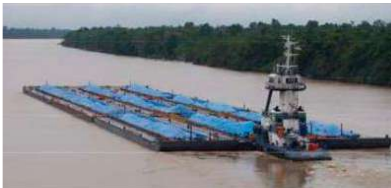
Figura 9: vista geral do comboio de 9 barcaças para transporte de minério vazias (esquerda) e totalmente carregadas (direita) Fonte: Nagado, Lukine e Mendonça, 2012.
