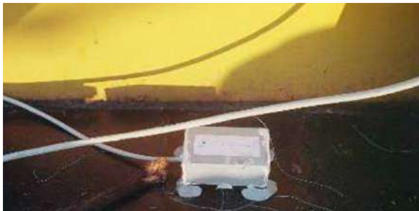
Figura 11: Modelo de acelerômetro posicionado no convés da barcaça de nº 6 para medição dos movimentos das barcaças durante o teste Fonte: Nagado, Lukine e Mendonça, 2012.
