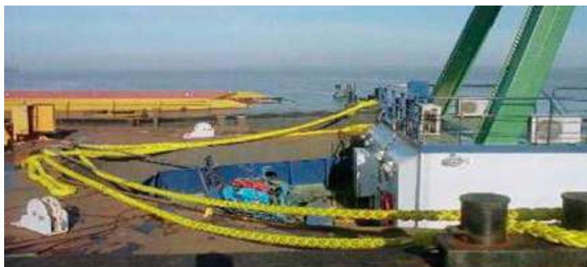
Figura 12. Amarração do comboio utilizando cabos de propileno (cor Amarela) de 4 polegadas Fonte: Nagado, Lukine e Mendonça, 2012.
