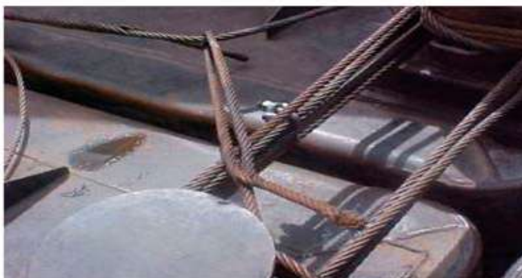
Figura 10: modelo de cabeços e de amarração utilizados para o estudo prático Fonte: Nagado, Lukine e Mendonça, 2012.
